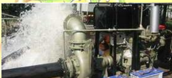
รูปที่ 34 ต้นกำลังที่เป็นเครื่องยนต์ใช้กับเครื่องสูบน้ำ
